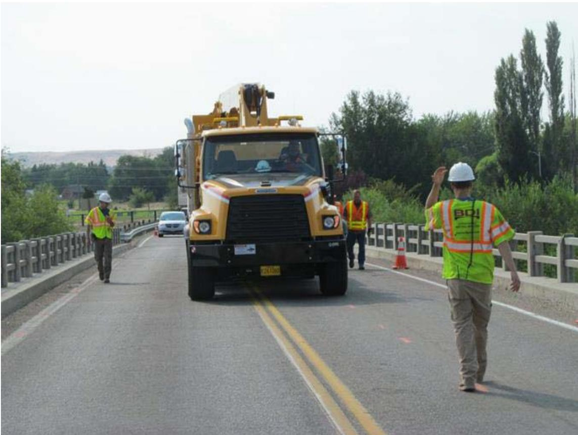
*Figure 3.22 Live-Load Test*
